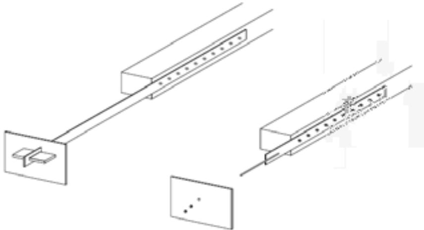
Particolare di lama d'ancoraggio di una trave in legno con la muratura
