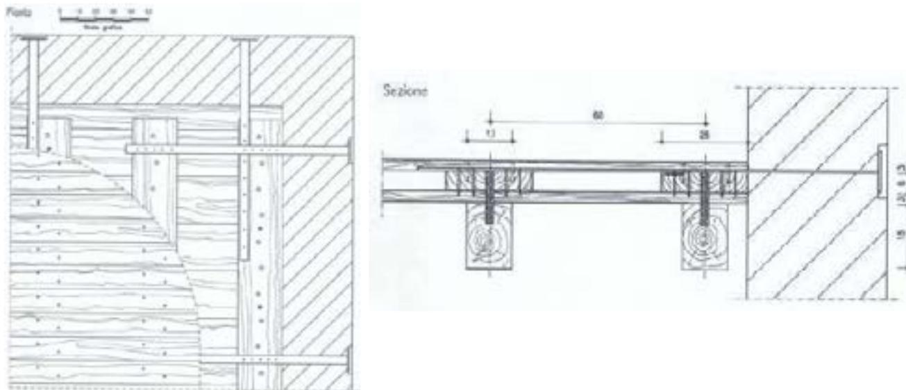
L'applicazione di bandelle metalliche è un sistema intermedio tra l'applicazione di un nuovo tavolato e la realizzazione di una soletta collaborante, anch'esse dovranno ancorarsi perimetralmente alle murature.
