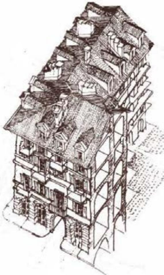
A livello costruttivo possiamo dire che si tratta per lo più di edifici a manica doppia, con orizzontamenti prevalentemente a padiglione anche ai piani superiori, tetti a falde di forma regolare, presenza di abbaini che, qualora numerosi già nello schema di impianto, denotano i sottotetti come spazi preordinati per l'abitazione.
