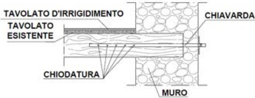
Esempio di collegamento trave di solaio - muro realizzato contemporaneamente all'irrigidimento del solaio ligneo
