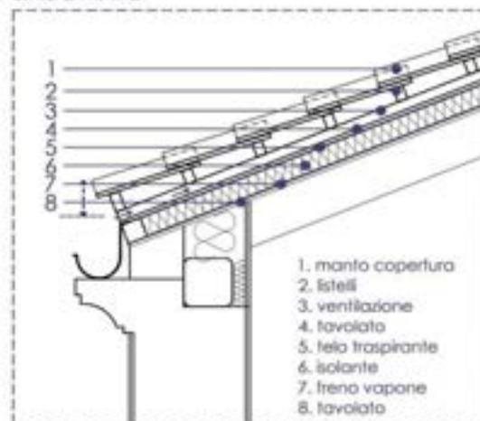
La normativa vigente impone per le coperture in zona climatica F valori di trasmittanza U molto stringenti: 0,24 W/m<sup>2</sup>K per il 2015, 0,22 W/m<sup>2</sup>K per interventi attuati dopo il 2021. E' chiaro che valori di U così contenuti significano spessori di isolante significativi (generalmente > 15 cm).
