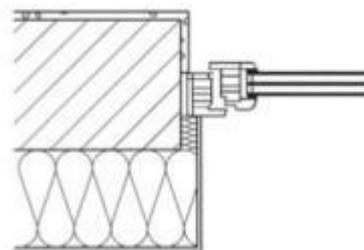
*Esempio con rivolto minimo dell'isolante: soluzione da evitare.*
